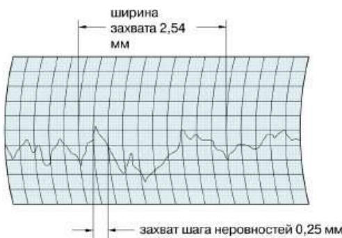
Рисунок 9: При увеличении ширины захвата показатель шероховатости изменяется.
